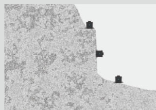
易发生位移塌方边坡 地质灾害边坡、水库大坝等边坡的倾斜位移实时监测
