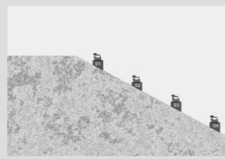
高速边坡护坡的监测 高速公路两侧护坡、铁路周边护坡的倾斜塌方的监测
