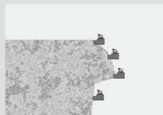
山体滚落崩塌 监测山体较大体积的岩石或不稳定的山体的崩塌坠落
