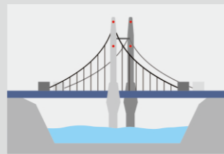
桥梁主梁倾斜监测 监测桥梁主体的长期倾斜量的变化
