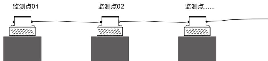
一台监测站可以连接两个或多个监测点，传感器左右两侧带有插孔，将连接线直接与插孔对插即可。
