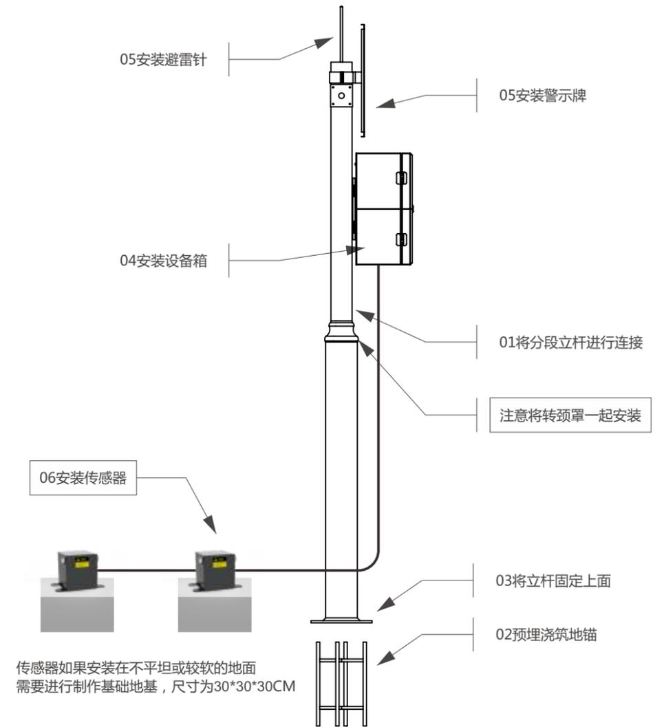
**!** 请使用波纹管走线安装，不可漏出内部线材，在安装完毕后，务必将立杆及设备箱出线孔，请使用胶圈密封，防止内部生锈，增加美观性
