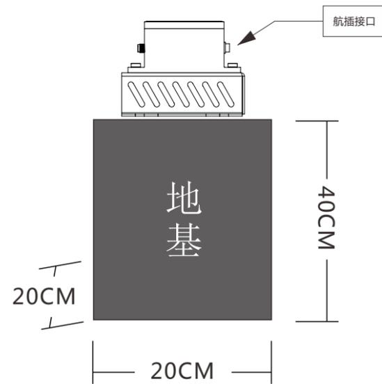
开挖基坑，使用水泥浇筑凝固后，在地基开孔使用膨胀螺丝将传感器固定在上面，保持稳定牢固。
