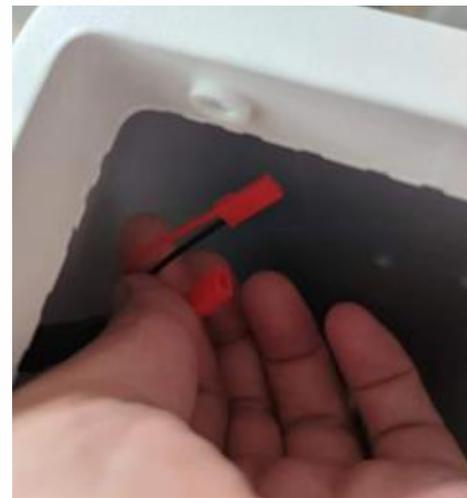
抓拍版主体热释电指示灯连接插头
